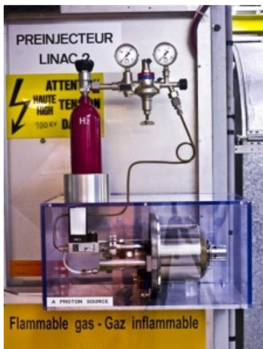
Il trucco sta proprio nel prendere gli atomi di idrogeno (che sono elettricamente neutri) , **strappare via loro l'elettrone** che orbita intorno al protone, e recuperare i protoni nudi per infilarli nel primo stadio della catena di accelerazione (di cui parleremo in un'altra occasione). Semplice, vero?
